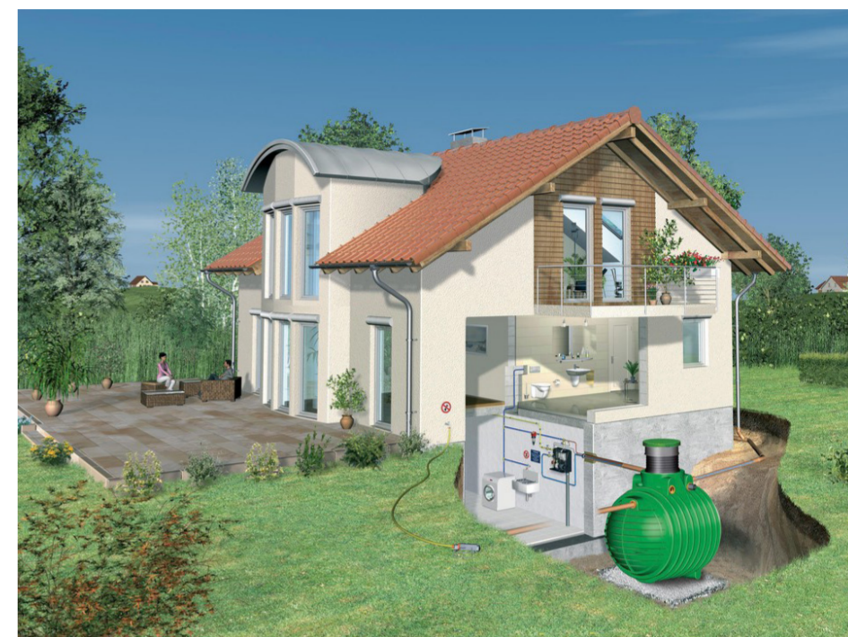
Použití dešťové vody pro závlivku zahrady a pro splachování wc Zdroj: https://voda.tzb-info.cz/docu/clanky/0099/009961o17.jpg
