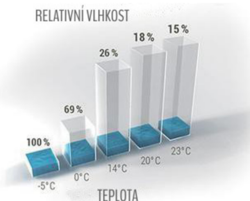
Závislost relativní vlhkosti vzduchu na teplotě Zdroj: https://www.stadlerform.cz/pruvodce-zvlhčovanim/
